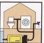
Hidrofor fara rezervor
