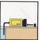
Hidrofor fara rezervor
